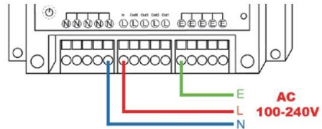
Способ подключения устройств к реле без нулевой линии
